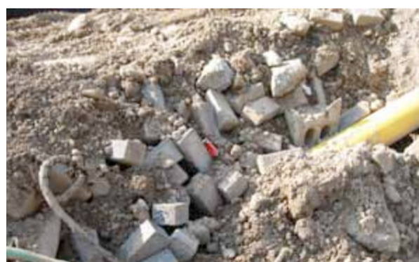
2. Bij het locatiebezoek wordt geconstateerd dat de locatie niet overeenkomt met de locatie ten tijde van de bemonstering. Hier en der liggen depots en in deze depots zijn significante hoeveelheden bodemvreemd materiaal aanwezig. Op basis van het locatiebezoek is de partij grond afgekeurd.
